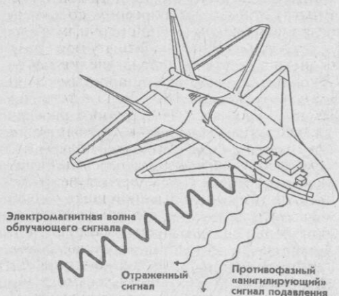
Рис. 4. Принцип радиоэлектронного подавления РЛС методом «аннигиляции» ее сигнала, отраженного от воздушной цели
